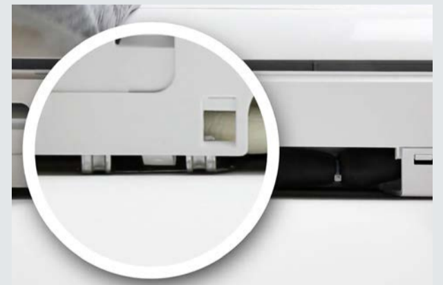
12. RICHIUDERE e riagganciare completamente l'unità alla piastra
