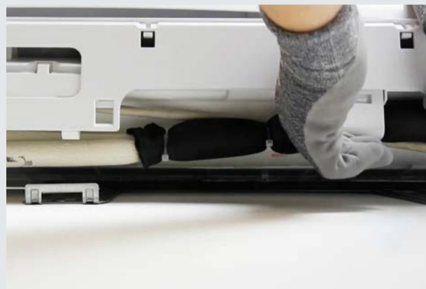
11. SISTEMARE i tubi nell'apposito alloggiamento
